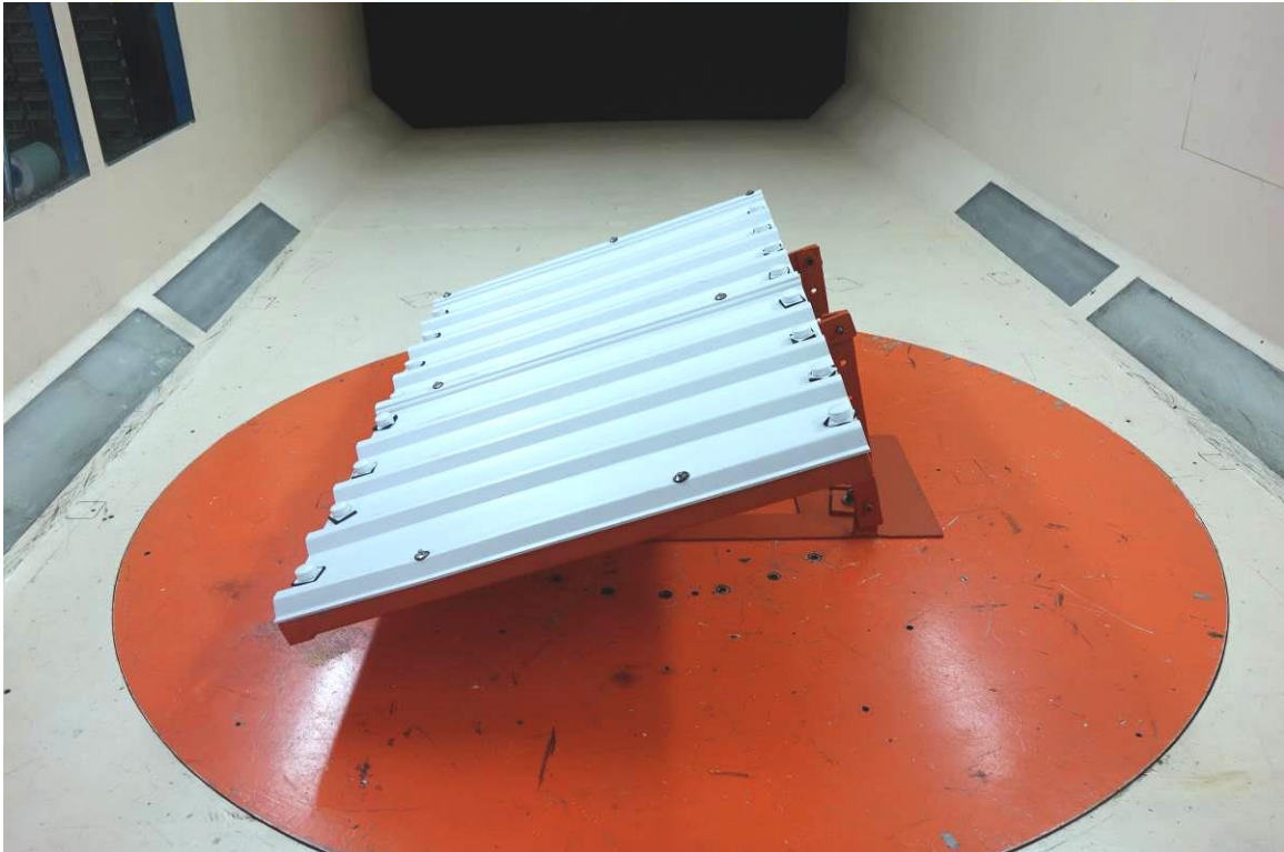
圖8、保旺PVC發泡浪板側面吹風背風面
