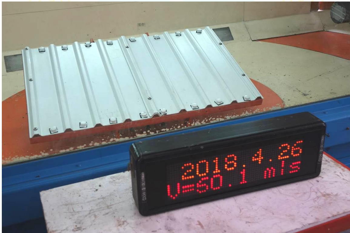
圖10、發泡浪板側面吹風達60.1 m/sec之外觀狀況
