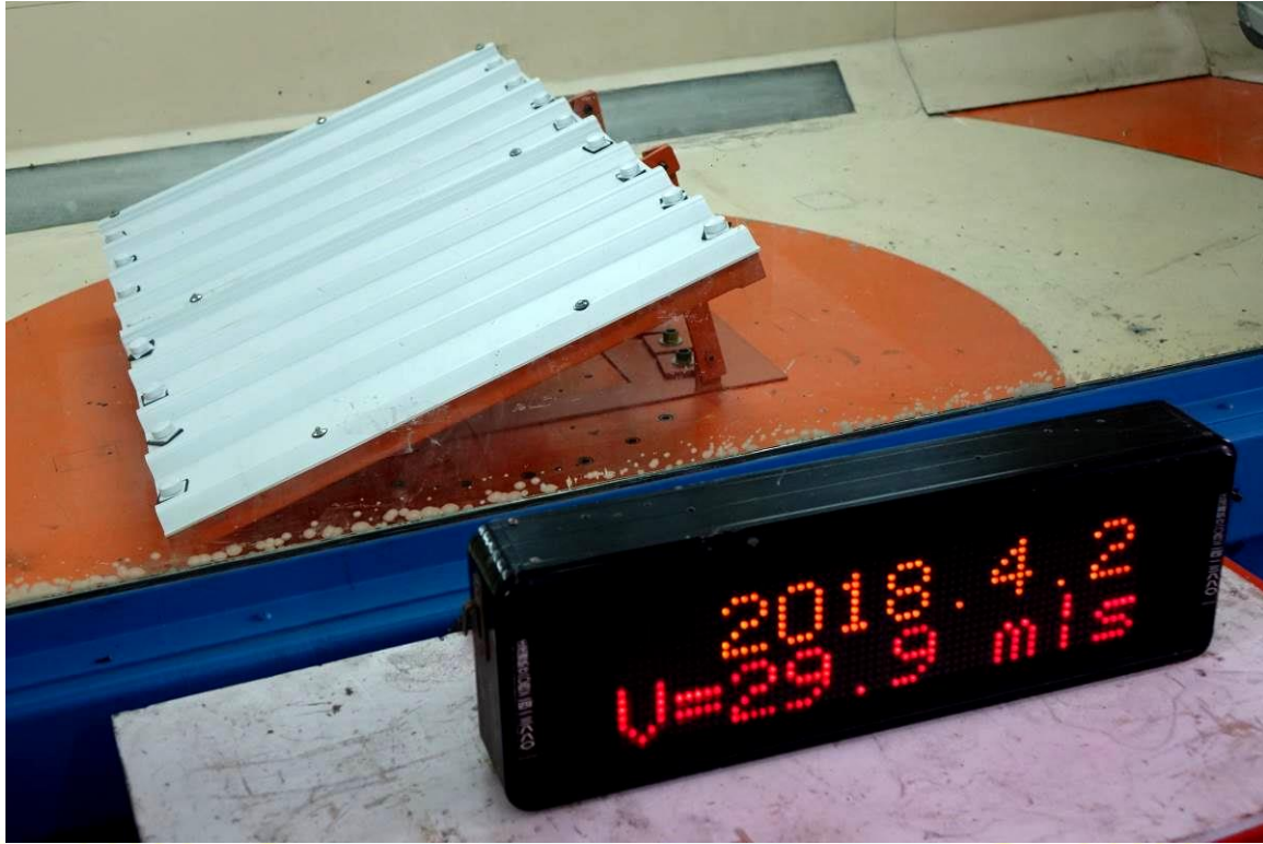
圖3、發泡浪板正面吹風達29.9 m/sec之外觀狀況
