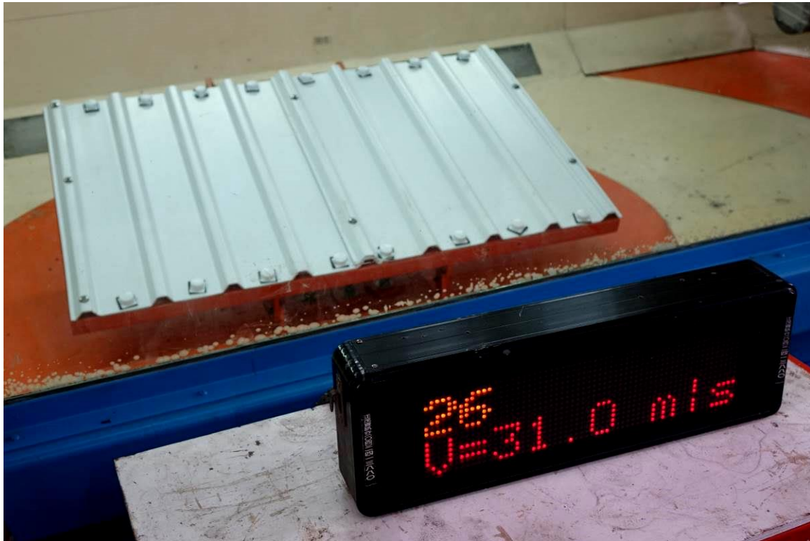
圖9、發泡浪板側面吹風達31.0 m/sec之外觀狀況
