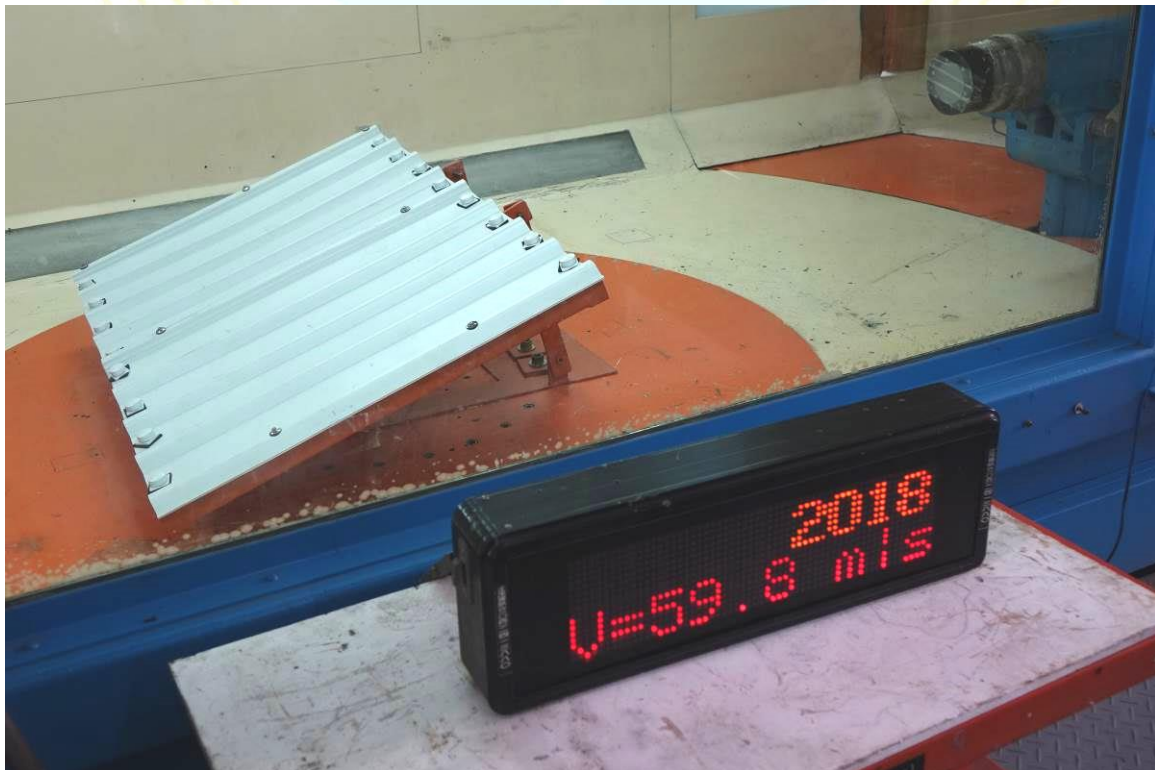
圖4、發泡浪板正面吹風達59.8 m/sec之外觀狀況
