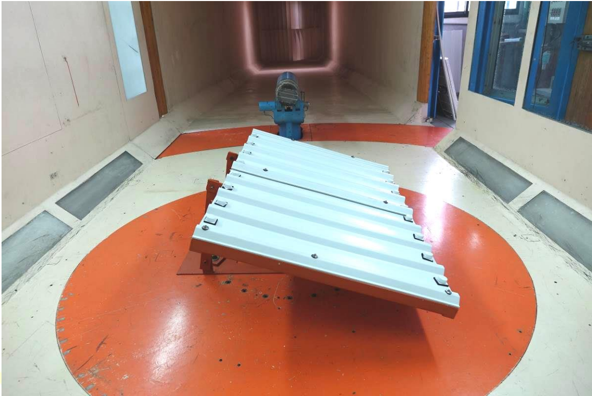
圖7、保旺PVC發泡浪板側面吹風迎風面
