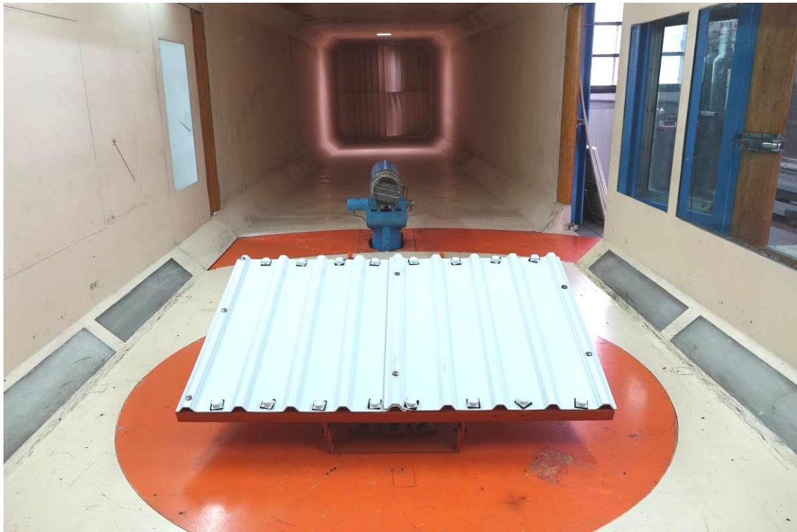
圖5、保旺PVC發泡浪板測試後迎風面，無脫落或損壞
